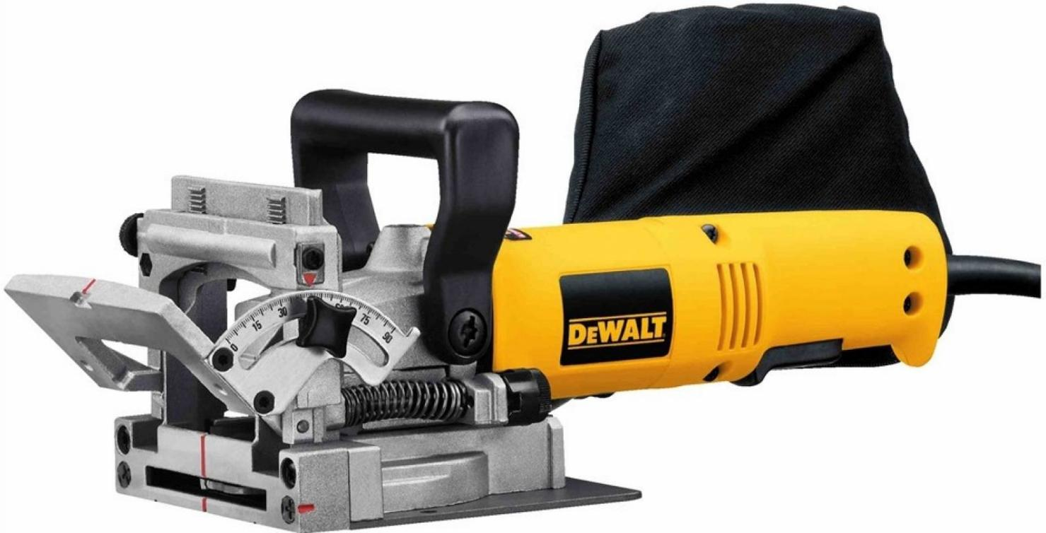
Guía de cremallera y piñón doble asegura que la cuchilla y la guía siempre estén paralelas / Guía de una pieza es ajustable y se mueve de 0 - 90° / Cortes lisos se pueden hacer a 0° sin remover la guía.
